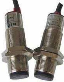
D、园柱型反射式光电开关：（作用同上）共有 3 条线，其中 2 条电源输入，棕色：+12V、蓝色：GND 和 1 条信号输出，当人经过反射式光电开关时（反射距离为 10-20mm）输出+12V，反之为 0V。
